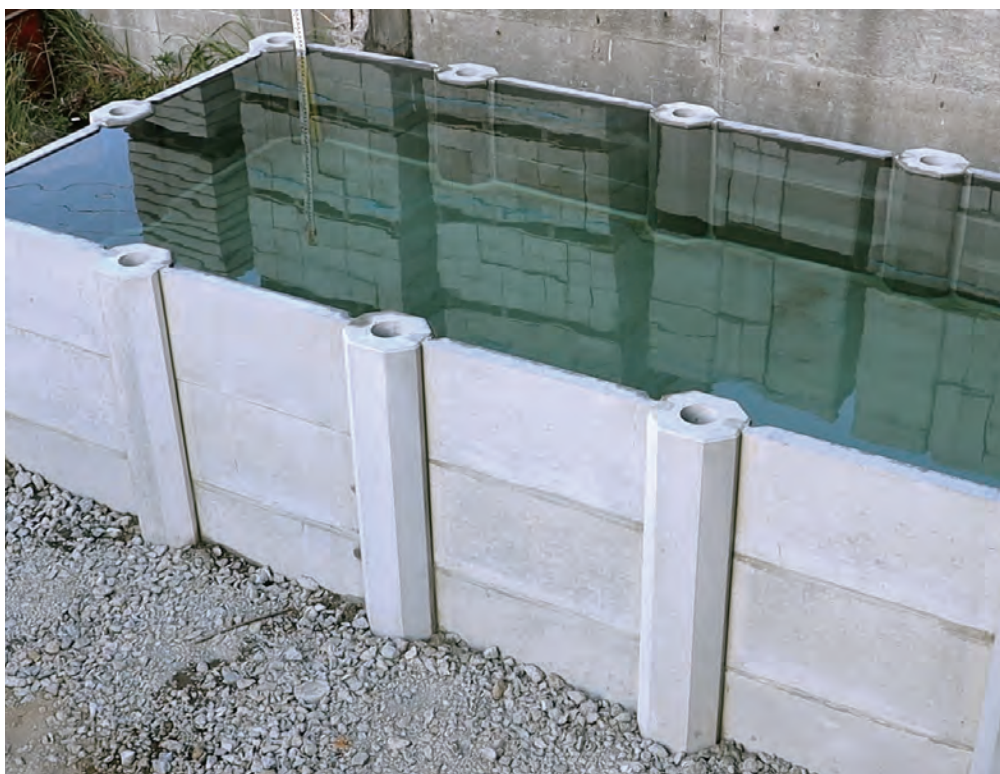
【ミヤコWG】貯水試験施設 見学可能(要事前連絡) 200日以上水漏れ無し
