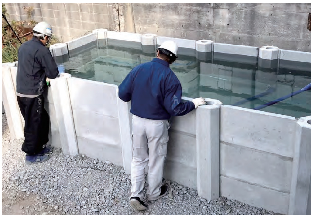
【ミヤコWG】貯水試験施設 見学可能(要事前連絡) 200日以上水漏れ無し
