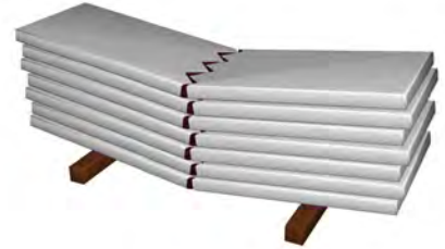
図2 悪い例 (角材が無い場合でも割れます)
